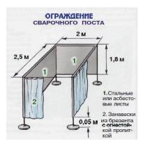
При использовании самозащитной проволоки (без газовых баллонов), пункт 6 не нужен, но каждая кабина должна быть герметичной с дополнительной общей вытяжкой не менее 1500 м3/ч.
